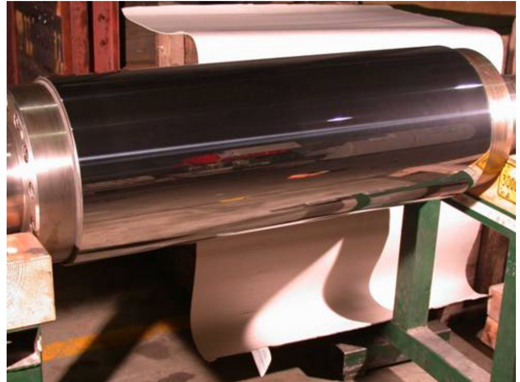
Mit DPC 169 Beschichtete Kalandervalze, Rauheit RA < 0,009 µM
