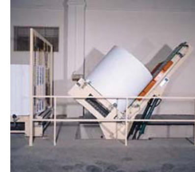
Rollenkipper minimieren das Risiko von Beschädigungen, wie sie bei der Verwendung von Klammerstaplern auftreten.
