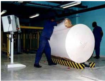
Auspackstationen Geeignet zur semiautomatischen Entpackung von Papierrollen in Druckereien.
