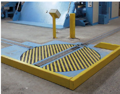
Drehscheiben Stabile Drehscheiben zur Änderung der Transport oder Wickelrichtung.
