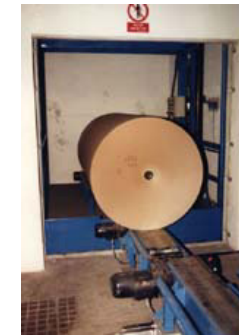
Hydraulisch betriebene Senkrechtförderer , überwinden Niveauunterschiede bis zu 10 m
