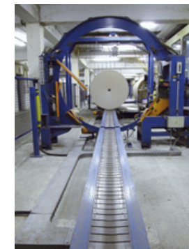
Stahlplattenförderer eignen sich bestens zum Transport von schwerer Paletten und Rollenware.
