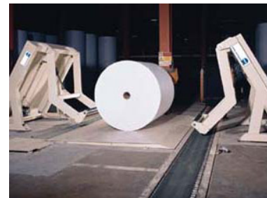
Rollenauswerfer und Fänger Sorgen für ein sanftes Auswerfen und Abstoppen der Rollen. Die Ausführung kann hydraulisch wie pneumatisch sein.
