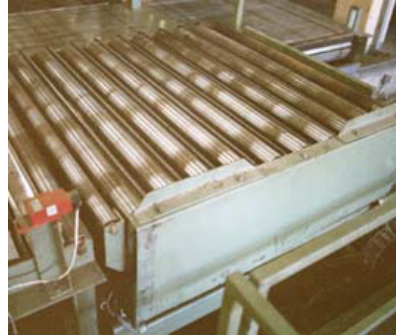
Kettenumsetzer Zur Änderung der Transportrichtung.
