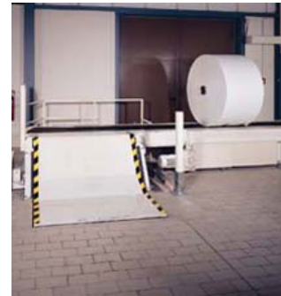
Rollenabsenkvorrichtung Senken die Rollen bei Transporteinrichtungen, die Überflur installiert sind, auf Bodenniveau.
