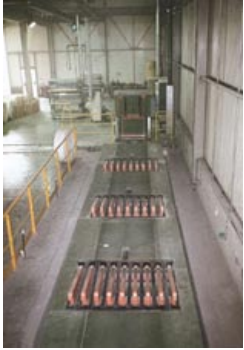
Abrollpodeste puffern die Rollenware schonend vor nachfolgenden Ver- und Bearbeitungsmaschinen.
